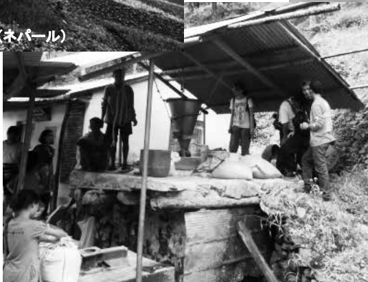
水力を使って日中は製粉機をまわし、 夜は発電をして家に明かりを灯す（ネパール・ピンタリ村）
